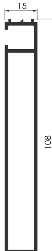
COD: RA 3/057 MARCO VENTANA DESPLAZABLE PESO: 0,837 Kg/m LARGO: 6200 mm.
