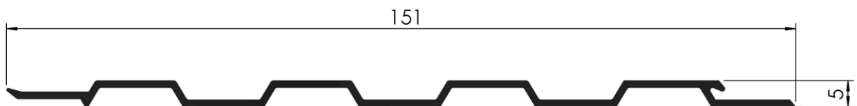
COD: RA 2/701 REVESTIMIENTO ACANALADO ANCHO PESO: 0,670 Kg/m LARGO: 6030 mm.
